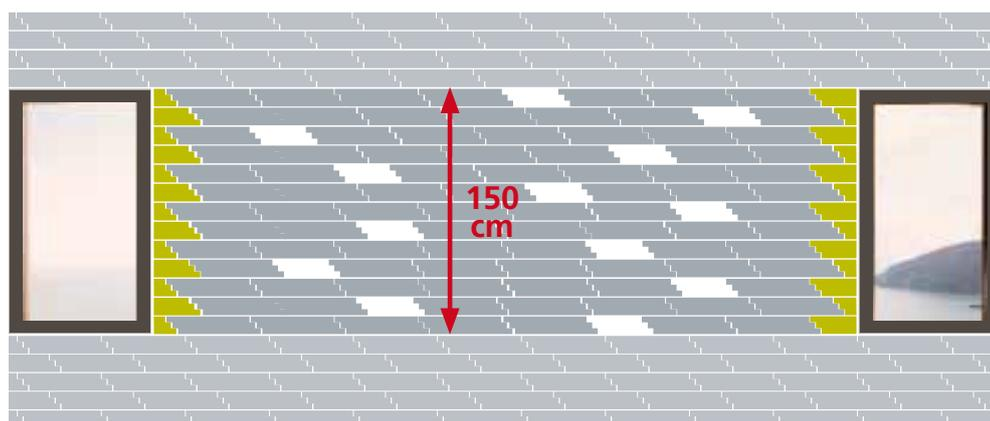
Zuerst die ECKELEMENTE von RIGO auf beiden Seiten verlegen, dann mit den Flachsteinen fortfahren, bis es keinen genügenden **Abstand für ein ganzes PANEEL gibt**. Der Abstand mit dem auf Maß geschnittenen Zuberhörteil LISTELLO einfüllen.
