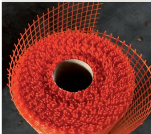
Georete è una speciale rete in fibra di vetro a maglia larga, con eccezionale resistenza meccanica, da utilizzarsi per rinforzare eventuali fondi non stabili o con poca resistenza. Georete, avendo un peso specifico superiore a 315 gr/m<sup>2</sup> supporta elevati carichi di trazione tanto da essere impiegata in alternativa alle tradizionali reti in ferro. Georete è utilizzata per la rasatura di supporto nei sistemi garantiti di posa di muregeopietra su isolamento termico esterno.
