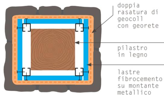
Per rivestire pilastri di legno e ferro ed evitare che le dilatazioni del materiale rompano il rivestimento è opportuno effettuare intorno al pilastro e leggermente staccato, uno scatolato con struttura per cartongesso e lastre in fibrocemento. Nel caso si utilizzino lastre antiumido in cartongesso, riportare anche cappotto in EPS. In entrambi i casi sarà necessario avvolgere poi con rete in fibra di vetro **Georete** affogata in doppia rasatura di collante **Geocoll**®.
