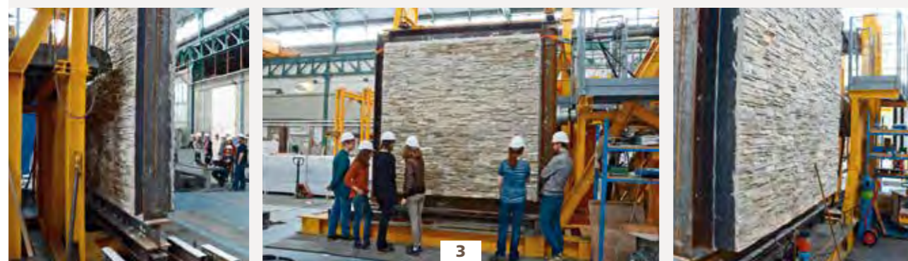
murogeopietra su blocchetti di cemento
